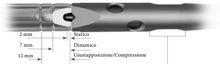
La fessura di compressione di 12 mm consente 7 mm di compressione (solo chiodi standard e distali)
